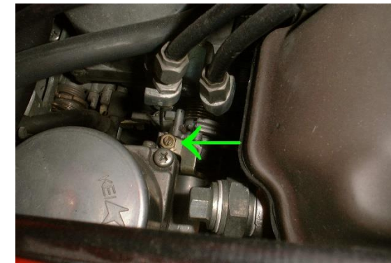
Synchronisierschrauben der Drosselklappen
