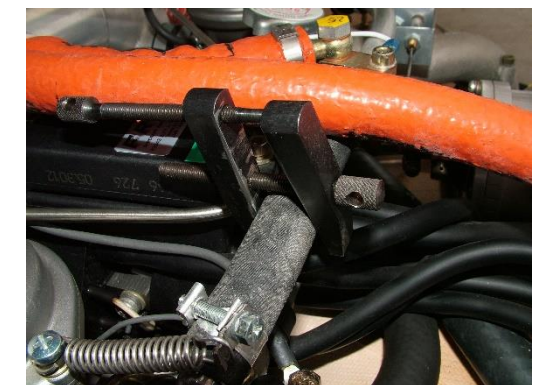
Abklemmen des Ausgleichsrohres am Rotax® Flugmotor 912
